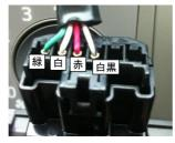
【マイナスコントロールの状態】 ※ハザード OFF / ON 電圧(V)変化
